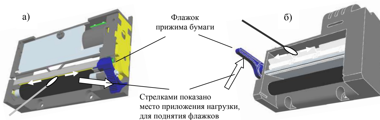
Рис. 28 - Чистка термоголовки принтера
