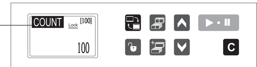
В режиме «Пересчет» если нажать на кнопку и удерживать ее в течение 1.5 сек, то режим пользователя будет выбран, и наоборот, если в режиме «Пользователя» нажать на кнопку режим пересчета будет выбран.
