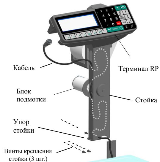
Рис. 3.3 - Сборка весов MK_RP10-1, MK_R2P10-1
