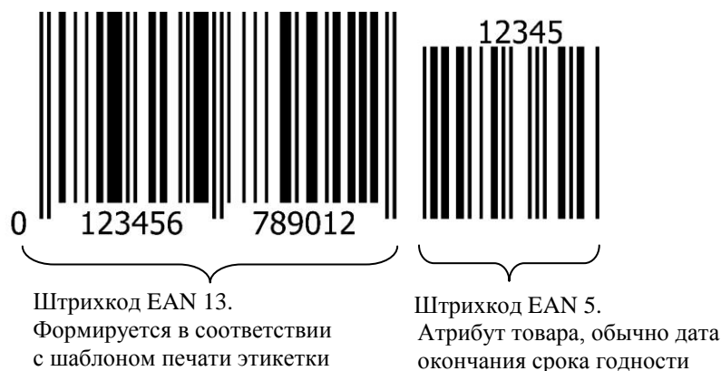
Рис. 6.2 – Структура штрихкода EAN 13+5
