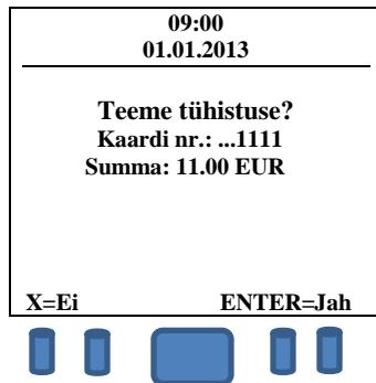
Для аннулирования сделки, нажмите зелёную клавишу. Для отмены аннулирования сделки, нажмите красную клавишу.
