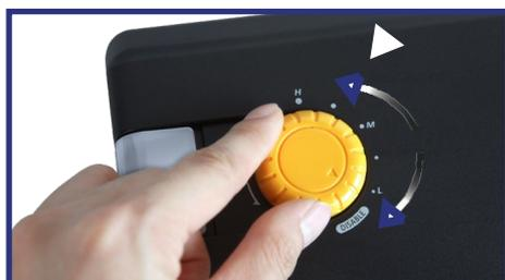
В конструкции принтера LK-B425 предусмотрена плавная настройка плотности прижатия термоголовки к бумаге. Поворотный переключатель на корпусе принтера позволяет настраивать принтер под разные типы бумаги без подключения к компьютеру, не программно, а вручную. Таким образом, персонал на месте может легко отрегулировать качество/интенсивность печати под любую бумагу.
