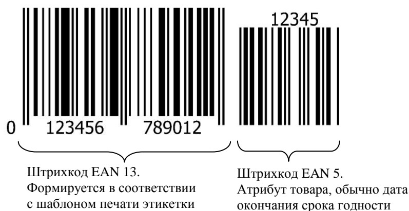
Рис. 7.2 – Структура штрихкода EAN 13+5
