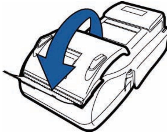
Рис. 11 Закрытие крышки отсека для бумаги
