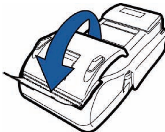
Рис. 15 Закрытие крышки принтера
