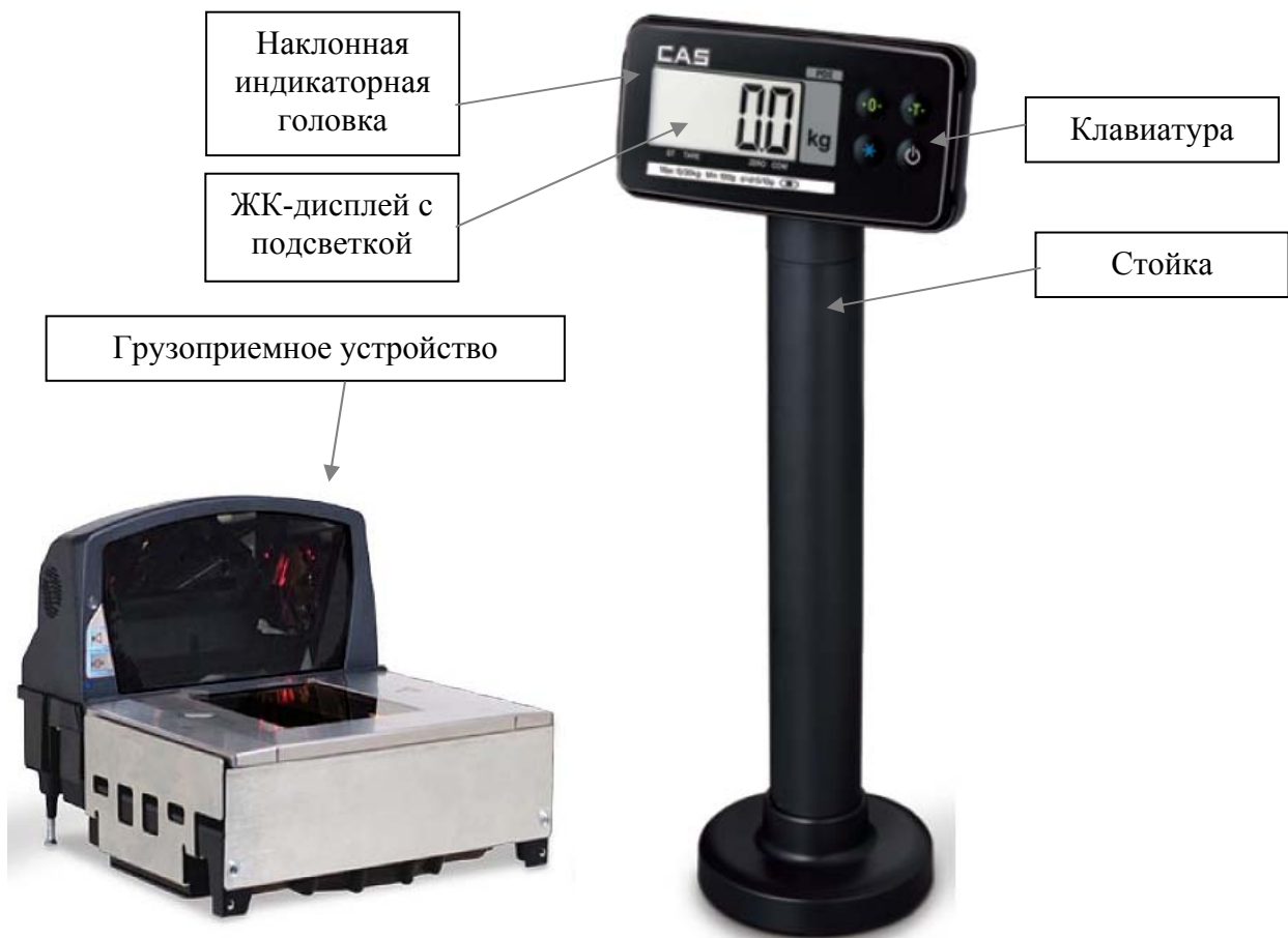
Рисунок 4.1 – Общий вид весов и обозначение основных элементов
