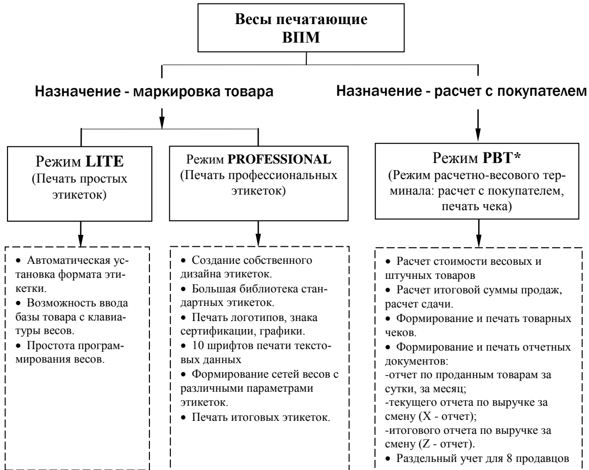
Рис. 1. Режимы работы весов ВПМ
