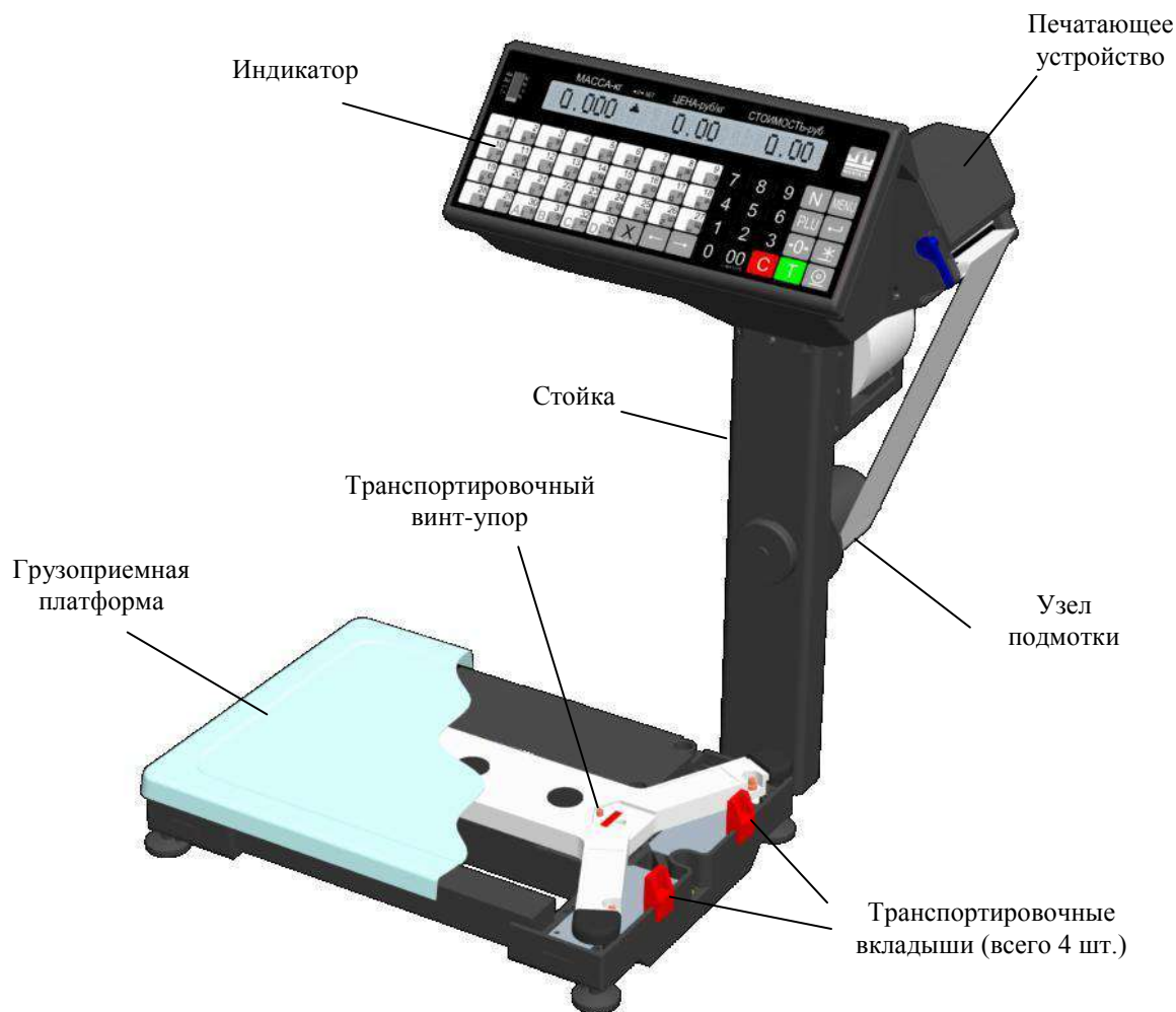
Рис. 3. Общий вид весов ВПМ_Т1
