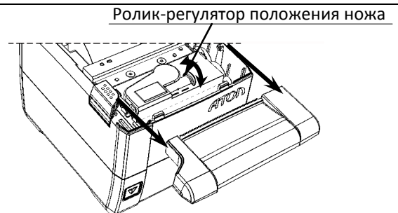
Рисунок 4. Ролик-регулятор положения ножа автоотрезчика
