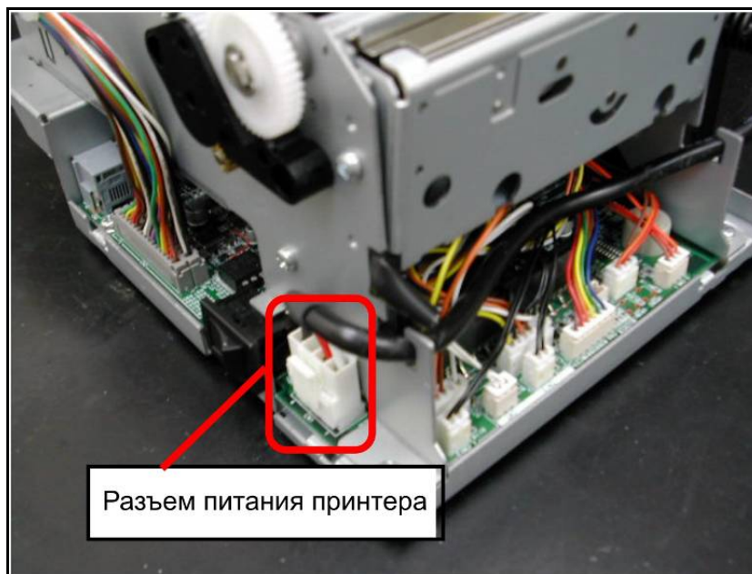
Рисунок 16 – Разъём питания принтера. Положение кабеля.
