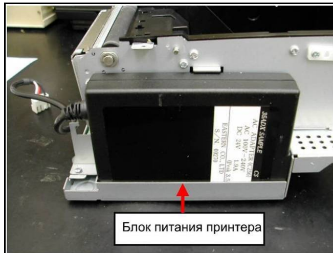
Рисунок 10 – Блок питания, установленный в принтере.
