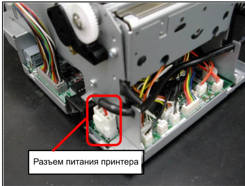
Рисунок 9 – Разъём блока питания принтера.
