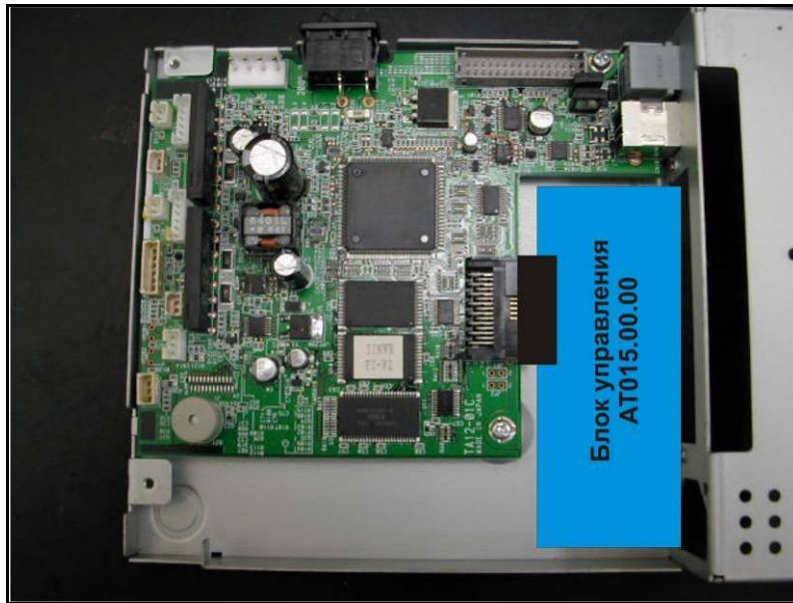
Рисунок 13 – Установка БУ в принтер.
