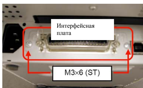
Рисунок 8 – Болты, крепящие интерфейсную плату принтера
