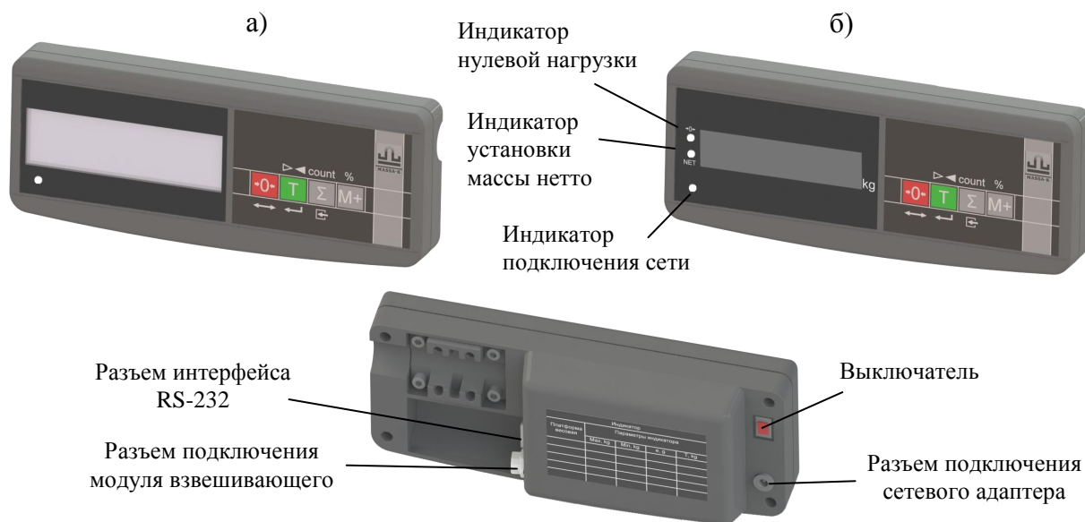
Рис. 2.1 - Терминал весовой А/ТВ Варианты исполнения: а) LCD индикатор; б) LED индикатор
