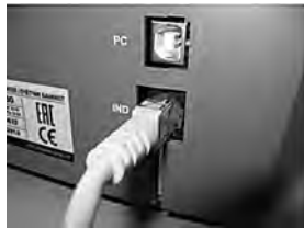
Рис. 5 Подключение дисплея к счетчику DORS 800.
