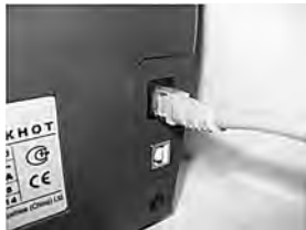
Рис. 4 Подключение дисплея к счетчикам DORS 700/750.
