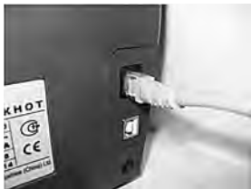
4-сурет. Дисплейдің DORS 700/750 есептегіштеріне жалғануы.
