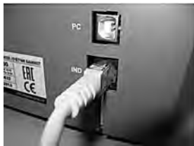
5-сурет. Дисплейдің DORS 800 есептегішіне жалғануы.
