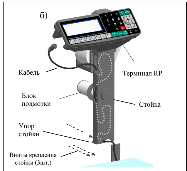
Рис. 3.3 - Сборка весов МК_RP10-1, МК_R2P10-1
