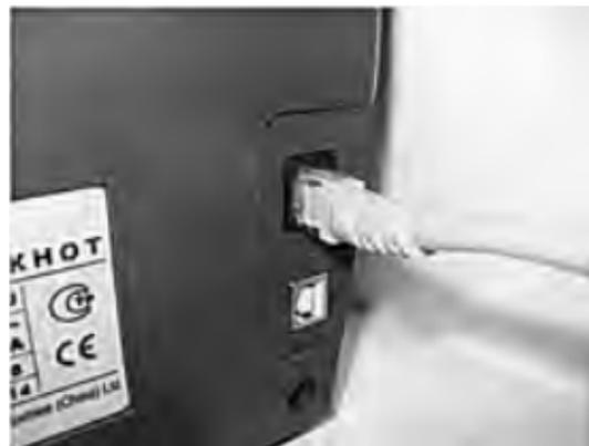
Рис. 4 Подключение дисплея к счетчикам DORS 700/750.
