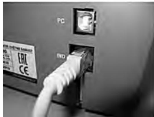
Рис. 5 Подключение дисплея к счетчику DORS 800.
