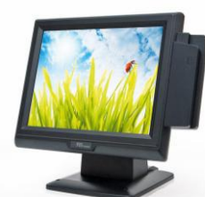
Считыватель магнитных карт MSR 1,2&3 дорожки.
